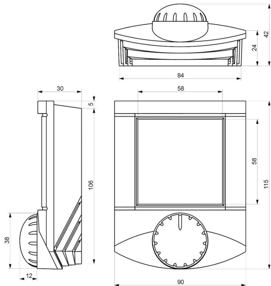
Všechny rozměry jsou v mm.
